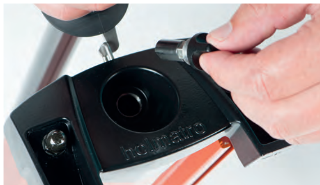
Zintegrowany wlew; łatwe i szybkie uzupełnianie oleju bez konieczności stosowania dodatkowych przyrządów
