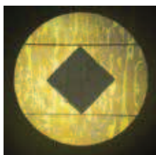
Odcisk przy próbie Vickersa
